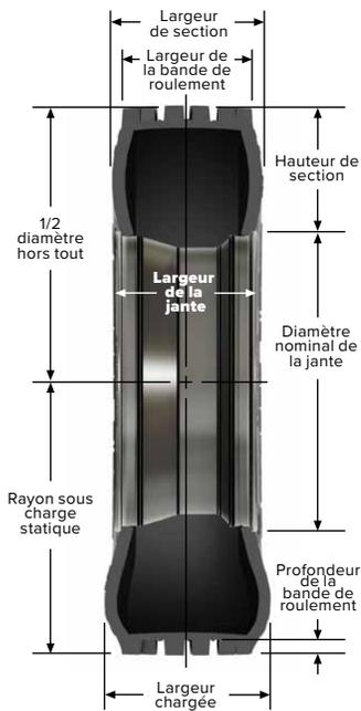
$$\text{Rapport d'aspect} = \frac{\text{Hauteur}}{\text{Largeur de section}}$$
